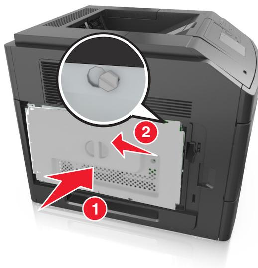
6 Aperte os parafusos da proteção da placa do controlador.
